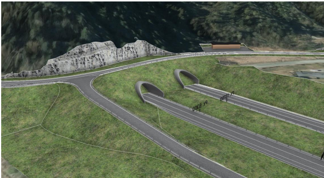
Figur 4-11: Illustrasjonen viser nordre tunnelportal. Det blir synlig fjellskjæring i bakkant som kan skjermes ved etablering av vegetasjon på arealet over tunnelportalene. (Kilde: Norconsult.)
